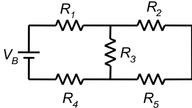
$$V_{325} = V_B - V_1 - V_4$$
